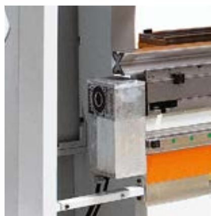
CNC-Bombierung mit Antrieb (*) Die CNC-Bombierung hat Verbindung mit der CNC-Steuerung, die Bombieren automatisch durchführt, so dass die Biegewinkel an allen Punkten des Werkstücks gleich werden * optional bis 400 to, darüber serienmäßig
