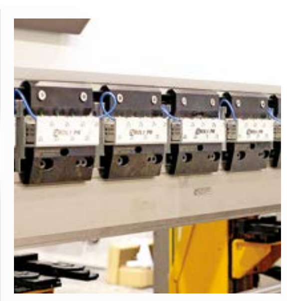
Druckluft-Werkzeughalterung (O) Drucklufthalterungen spannen und zentrieren das Werkzeug automatisch mit Druckluft: die perfekte Lösung für kurze Rüstzeiten an automatischen Abkantpressen
