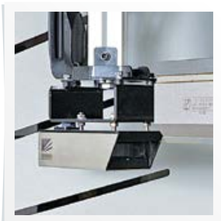
Laser Safe (O) Führendes Schutzsystem, besonders für Abkantpressen, für optimalen Arbeitsschutz
