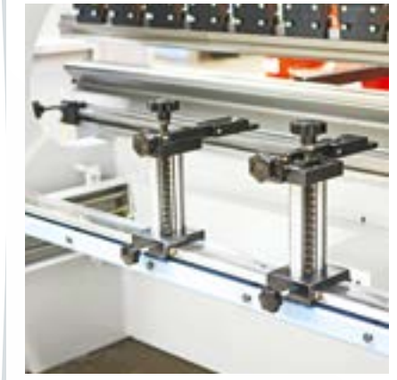
Finger für Hinteranschlag (S) Besonders konstruierte Finger für Hinteranschlag
