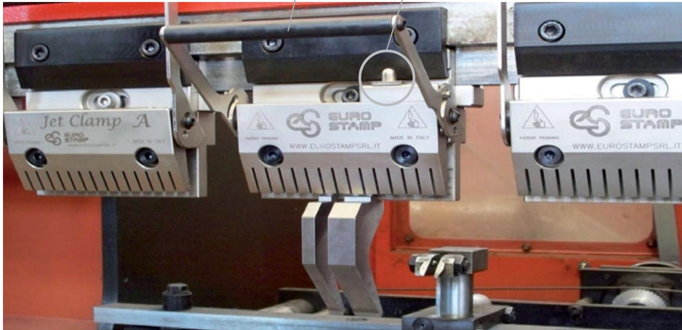
Mit dem **neuen Spannsystem JET CLAMP** können Amada-Promecam Oberwerkzeuge vertikal und horizontal gewechselt werden. JET CLAMP Spannsysteme sind mit 27mm und 40mm Zwischenstücken sowie Vorder- und Hinterklemmung erhältlich. Die Verriegelung ist in beiden Fällen von vorne zugänglich.
